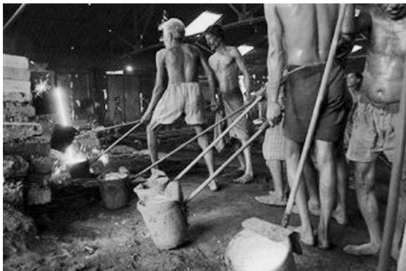
Рис. 8. а) Индийские рабочие делают крышки канализационных люков для Нью-Йорка
